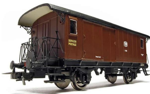
D681/683. I vari elementi sono disegnati con programmi di progettazione 3D, depositati con processo di prototipazione rapida e replicati successivamente in modo professionale in resina di alta qualità.
