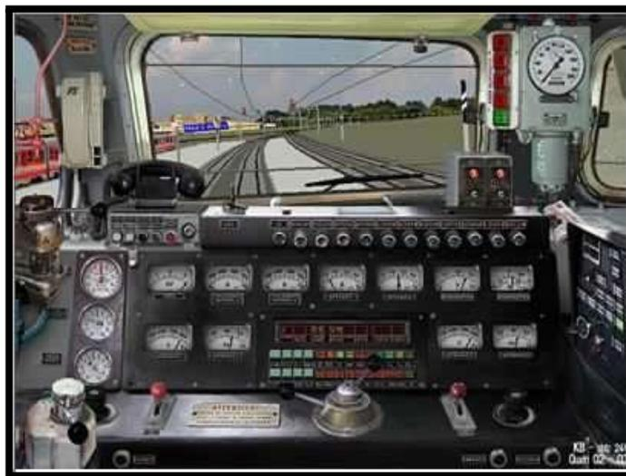
Si tratta di un programma che simula la guida del treno ponendo particolare attenzione agli aspetti tecnici e normativi. I mezzi di trazione simulati sono: E444R, E444, E656, E655, E646, E645 serie 300, E402b, E464, Ale 642, TAF, Minuetto elettrico, Minuetto Diesel, ETR 500. Le vetture pilota simulate sono: pilota piano ribassato, pilota media distanza, pilota UIC-X, pilota Vivalto e pilota Z1.
